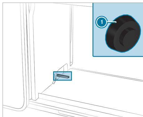
Tipka za aktivaciju u nuždi ❶ nalazi se u ormariću ispod plinskog kuhalja u šupljini za zaporni ventil spremnika otpadne vode (lijeva bočna stijena).
