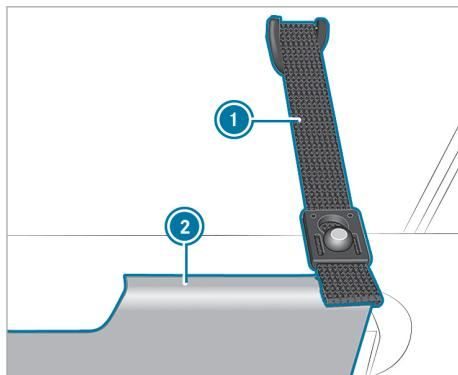
Pričvrstni pojaz za okvir kreveta (primjer lijeve strane vozila)
