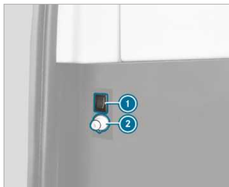
Raccord pour la douche extérieure
