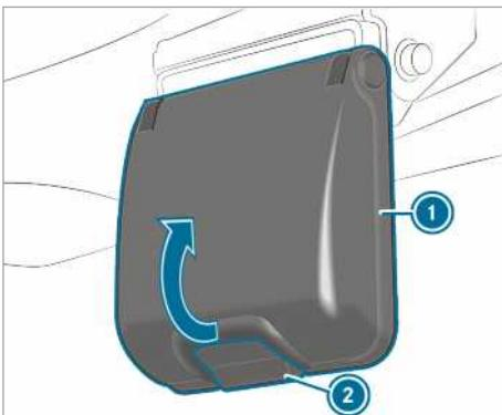
Zatvarač krova (primjer suvozačeve strane)
