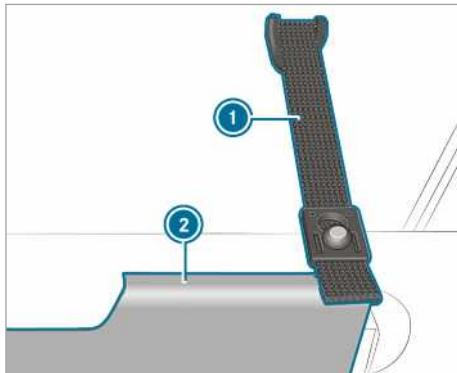
Pričvrsni pojas za okvir kreveta (primjer lijeve strane vozila)
