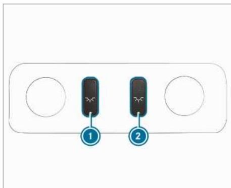
Iznad kombinacije sjedala i ležaja nalazi se unutarnje svjetlo u presvlaci krova s unutarnje strane. Srednji dio svjetiljke automatski se uključuje, integrirano svjetlo za čitanje lijevo i desno uključuje se ručno.
