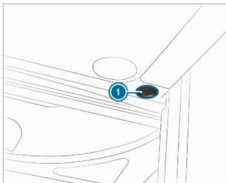
Svetla u interijeru nalaze se s obje strane pored krovnog pretenca za odlaganje i uključuju se i isključuju pojedinačno.
