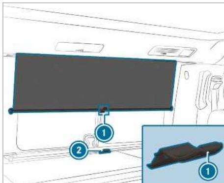
Svi prozori u putničkom prostoru opremljeni su neprozirnim roletama za zaštitu od sunca. Otvorite sve rolete za zaštitu od sunca prije početka vožnje. U suprotnom bi moglo iskočiti iz držača tijekom vožnje i ošteti se. Osim toga, zatvorene rolete za zaštitu od sunca ograničavaju pogled na stražnju i bočnu stranu.
