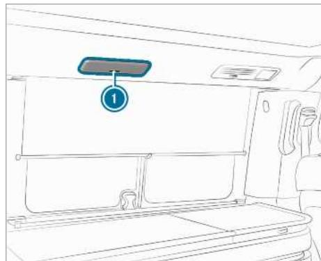
LED svjetla nalaze se u krovnom okviru s obje strane vozila između B i C stupova. Objema LED svjetlima može se upravljati automatski i ručno. Osim toga, na raspolaganju su i tri stupnja prigušivanja LED svjetala.
