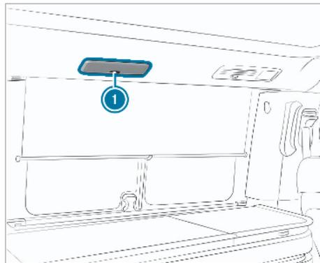
LED svjetla nalaze se u krovnom okviru s objiju strana vozila između B i C stupova. Objema LED svjetlima može se upravljati automatski i ručno. Uz to se LED svjetla mogu postupno prigušiti.
