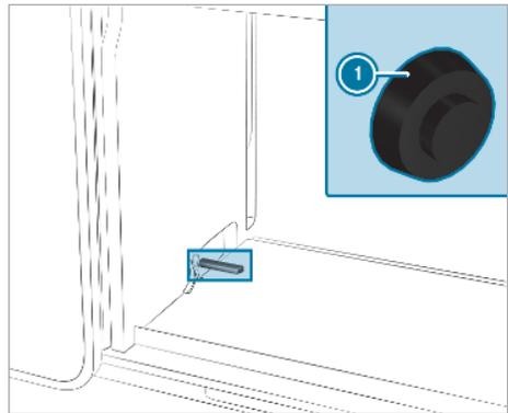
Tipka za aktivaciju u nuždi **1** nalazi se u ormaru ispod plinskog kuhala u šupljini za zaporni ventil spremnika otpadne vode (lijeva bočna stijena).
