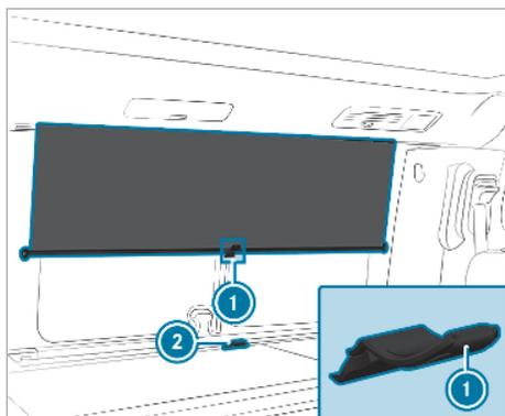
Svi prozori u putničkom prostoru opremljeni su neprozirnim roletama za zaštitu od sunca. Otvorite sve rolete za zaštitu od sunca prije početka vožnje. U suprotnom bi mogle iskočiti iz držača tijekom vožnje i oštetiti se. Osim toga, zatvorene rolete za zaštitu od sunca ograničavaju pogled na stražnju i bočnu stranu.
