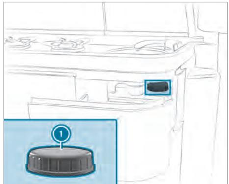
Deckel der Reinigungsöffnung des Grauwasserbehälters
