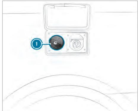
Der Einfüllstutzen für den Frischwasserbehälter **1** befindet sich hinter der Serviceklappe im Heckbereich auf der Fahrerseite.
