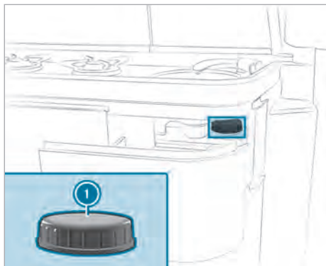
Coperchio del pozzetto di pulizia del serbatoio delle acque grigie
