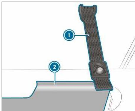
Sangle de retenue du cadre de lit (exemple: côté gauche du véhicule)
