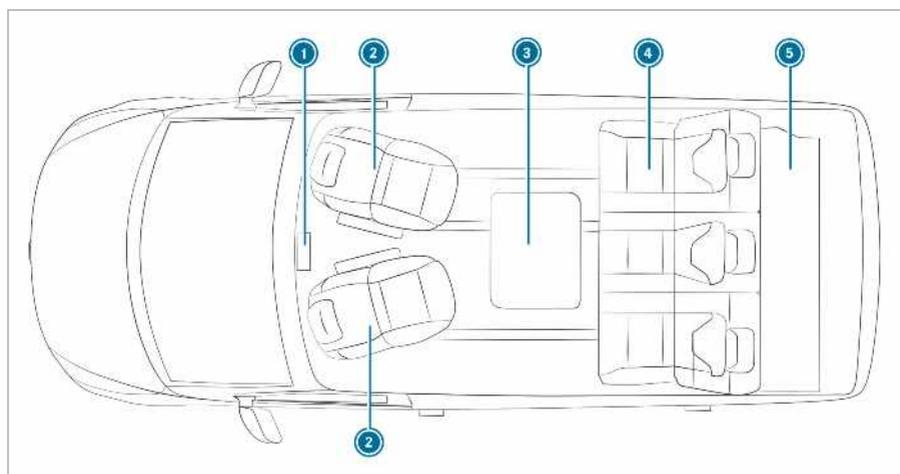
① Unité de commande chauffage autonome (voir la notice d'utilisation du véhicule)
