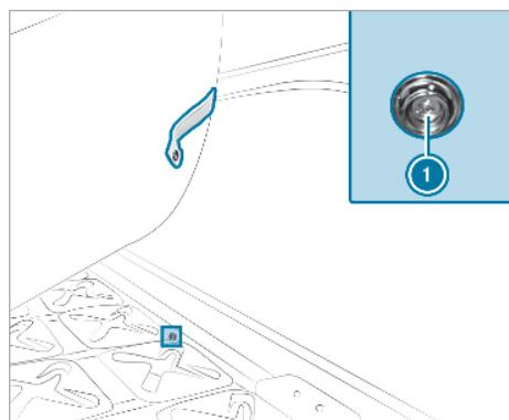
► Ανασηκώστε το στρώμα και στερεώστε το δίχτυ ασφαλείας στα προβλεπόμενα πλήκτρα πίεσης ① του πλαισίου κρεβατιού.
