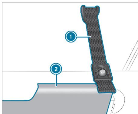
Ιμάντας συγκράτησης του πλαισίου κρεβατιού (παράδειγμα στην αριστερή πλευρά οχήματος)
