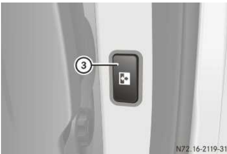
Schiebetür-Taste am Türeinstieg (B-Säule)
