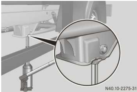
Wagenheber-Aufnahmepunkt, Hinterachse (Beispiel Pritschenfahrzeug 5 t)
