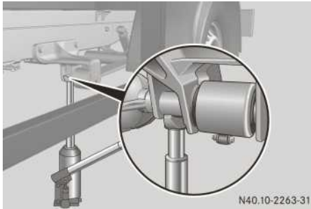
Wagenheber-Aufnahmepunkt, Hinterachse (Beispiel Pritschenfahrzeug bis 3,5 t)
