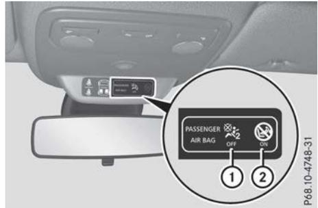
Die Kontrollleuchten PASSENGER AIR BAG OFF ① und PASSENGER AIR BAG ON ② sind Teil der Airbagabschaltung des Beifahrer-Airbags.
