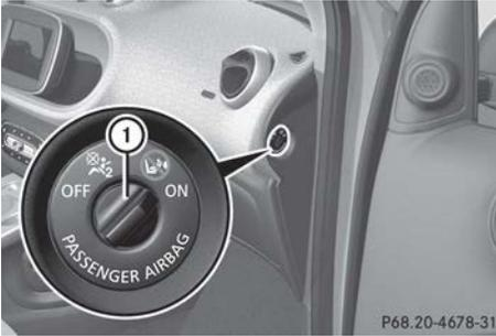
Der Airbag-off-Schalter zum manuellen Ein- und Ausschalten des Beifahrer-Airbags ist in der Instrumententafel auf der Beifahrerseite.
