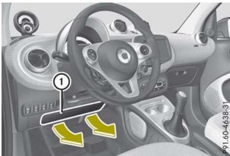
Der Fahrer-Kneebag ① entfaltet sich unterhalb der Lenksäule. Der Fahrer-Kneebag wird zusammen mit den Front-Airbags ausgelöst.
