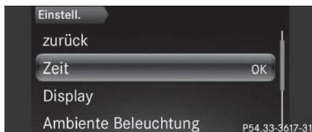
Im Menü **Einstellungen** und in dessen Untermenüs wird zusätzlich im Kopfbereich des Display-Anzeigefelds eine Navigationszeile eingeblendet. Die Navigationszeile dient der schnellen Orientierung und zeigt den Navigationspfad zur aktuell im Display gezeigten Auswahl (Untermenü/Funktion). Die im Display gezeigte Auswahl ist im Navigationspfad hervorgehoben. Abhängig von der Fahrzeugausstattung können Sie im Menü **Einstellungen** folgende Untermenüs aufrufen:
