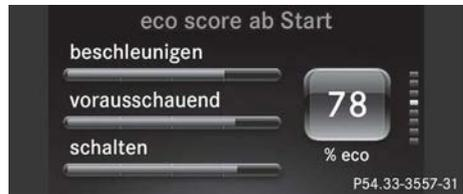
Der Prozentwert der eco score-Anzeige wird erstmalig nach einer Wegstrecke von etwa 400 m angezeigt. Ein hoher Prozentwert kennzeichnet einen ökonomischeren Fahrstil. Wenn die Zündung länger als 4 Stunden ausgeschaltet ist, wird die eco score-Anzeige im Bordcomputer automatisch zurückgesetzt.
