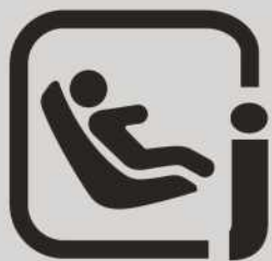
Symbol für Befestigung eines i-Size-Kinder-Rückhaltesystems
